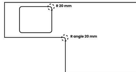
Pour les plans en céramiques et quartz (Dekton, Laminam, Neolith, Silestone) un rayon de 20 mm est indispensable lors des découpes d'angles et de réservations pour éviter un départ de fissure.
