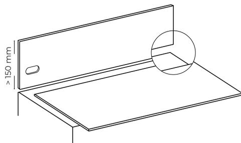
Les crédences cuisinistes peuvent être posées avant nos plans de travail à condition de prévoir l'épaisseur nécessaire. Compter au minimum 3 mm de jeu pour les plans en 12, 20 et 30 mm
