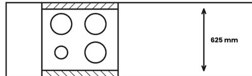
Si la profondeur de votre plan est inférieure à 625 mm et nécessite une réservation, des barettes seront installées.
