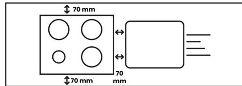
Une distance minimum de 70 mm à l'avant et à l'arrière d'une réservation (cuisson, évier, ...) est à prévoir.
